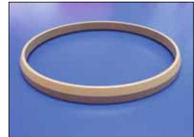
Weiteres Beispiel für einen Dichtring in Kugelventilen. ZX-530 wird bis über 180°C wegen der im Vergleich zu PTFE hervorragenden Zeitstandsfestigkeit und guten Gleiteigenschaften eingesetzt.
